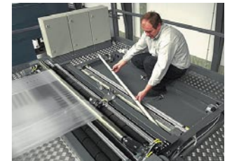
Remplacement facile du bloc soudure-coupe. Aucun outil requis. Il suffit d'ouvrir le « verrou à cliquet » et d'extraire le bloc de soudure magnétique et de le remplacer par un bloc de rechange.
