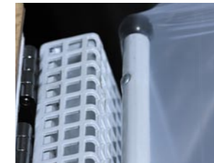
Contrôle pneumatique des doigts. Garantit que le film est toujours correctement placé sur les doigts.
