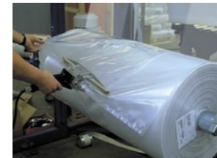
Remplacement facile du film au niveau du sol. La fin de bobine est tout simplement soudée, collée ou attachée à l'extrémité de la nouvelle bobine et amenée automatiquement à travers le système de déroulement de film.
