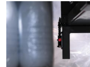
Contrôle du gabarit : le processus s'interrompt si les cellules photoélectriques sont réfractées pendant le mouvement de descente.
